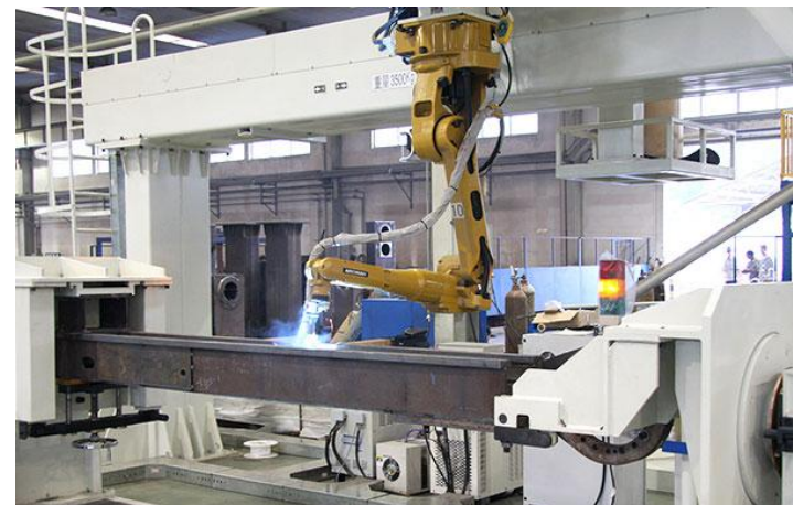
三一重工星沙工厂吊臂焊接项目
